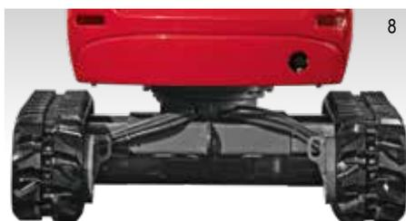
LARGEUR DU TRAIN DE ROULEMENT DÉPLOYÉ 1 300 MM
