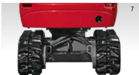
LARGEUR DU TRAIN DE ROULEMENT RÉTRACTÉ 980 MM
